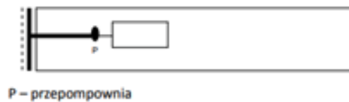
Rysunek 2. Kanalizacja ciśnieniowa
